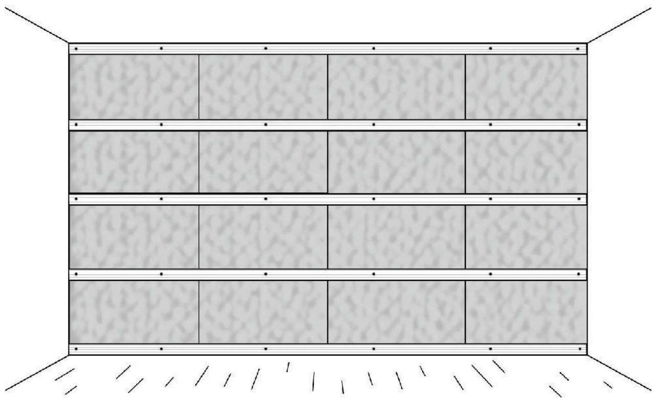
Vložte 45 mm. minerálnu vlnu medzi laty. Minerálnu vlnu je možné rezať pomocou noža. Minerálna vlna sa potom vtlačí medzi laty.
