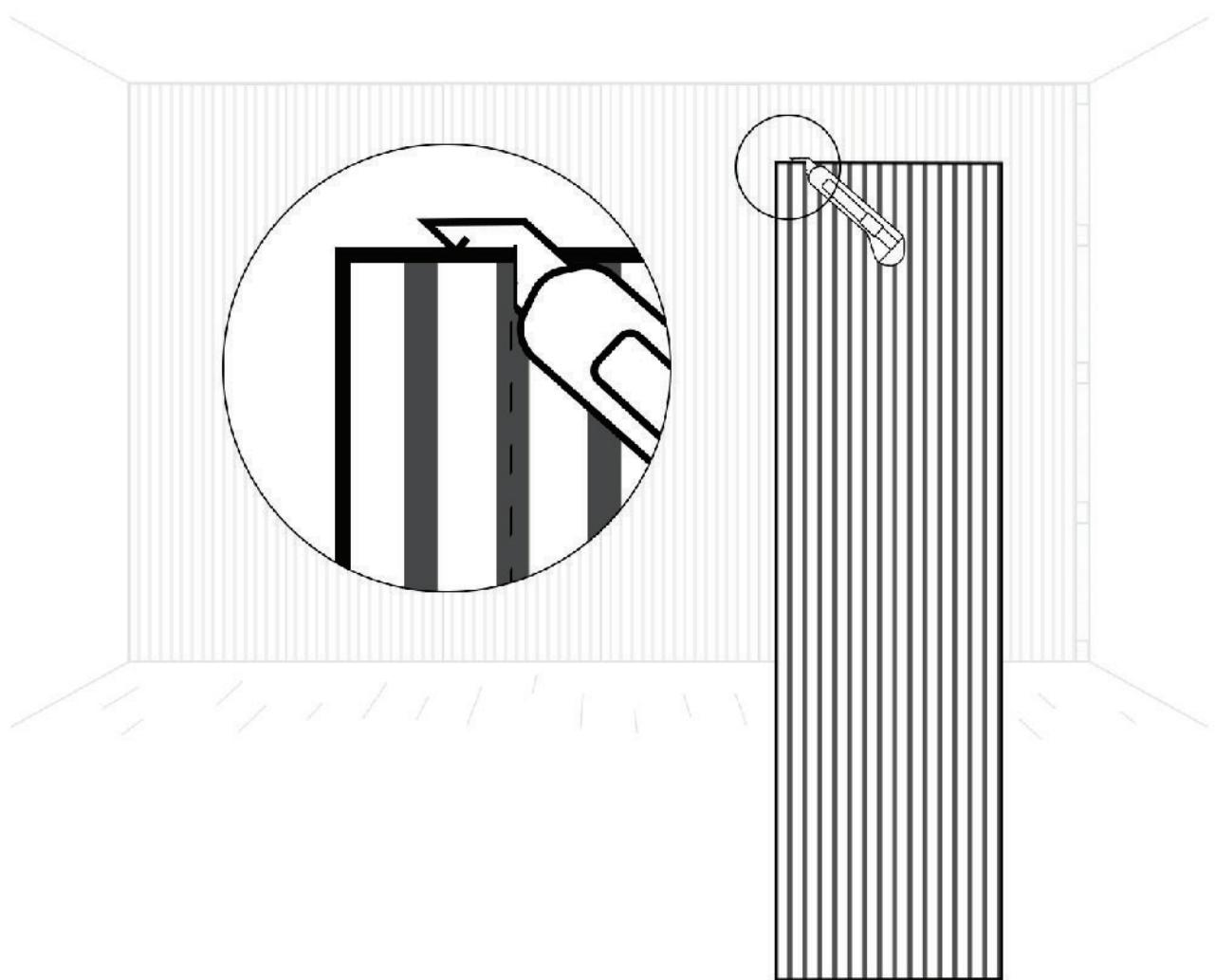
Bočné napasovanie akupanelov sa vykonáva rezaním panelu cez plst', pomocou noža.
