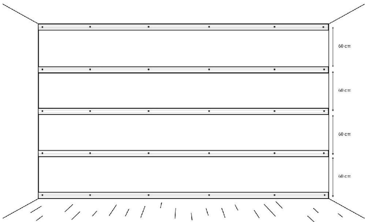
Prvá vec, ktorú musíte urobiť, je namontovať laty na stenu. Podľa typu steny zvoľte hmoždinky a skrutky, ktorými pripojíte laty o stenu. My odporúčame dodržať vzdialenosť 60 cm, medzi latami.
