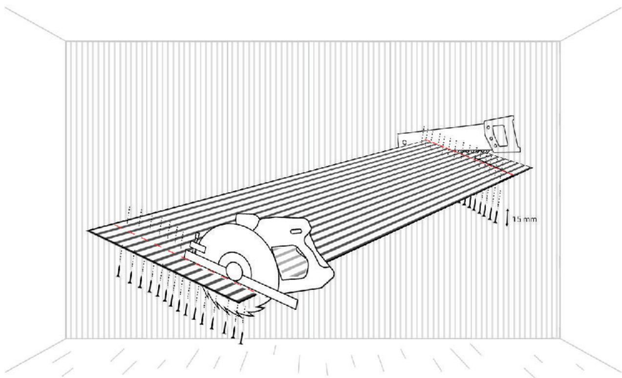
Ak potrebujete upraviť výšku Akupanelov, môžete tak urobiť pomocou píly a to napríklad kotúčovou pílovou alebo klasickou pílkou. Na panel ceruzkou označte čiaru rezu.
