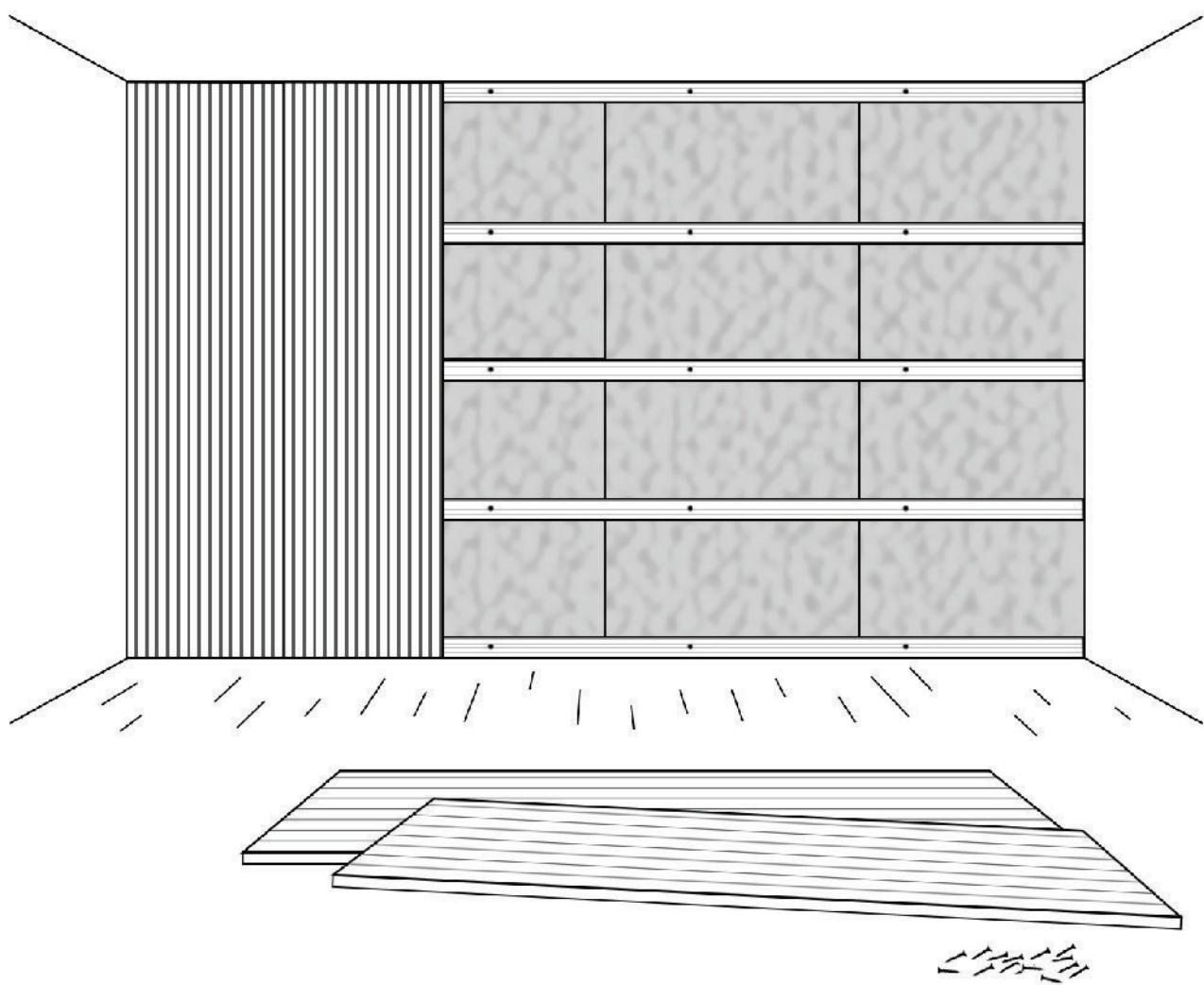
Panely majú plstenú stranu a lamelovú stranu. Ked' sa montujú panely vedľa seba je potrebné zabezpečiť, aby plstená strana z jedného panelu bola zarovnaná so stranou lamely na inom paneli tak, aby medzi lamelami bolo asi 12 mm medzera.
